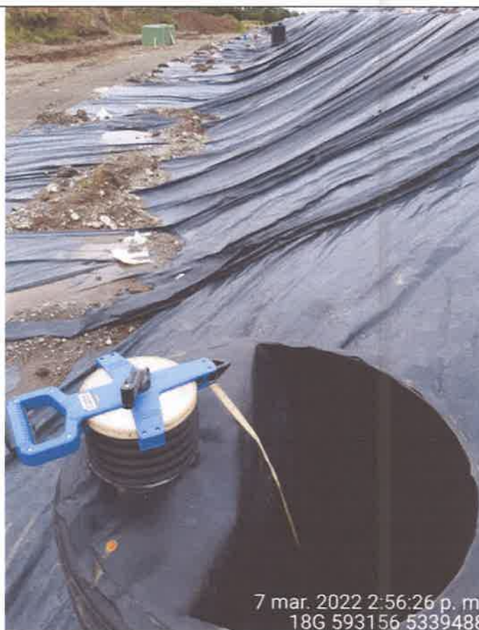
Fotografía N°16: Medición de Niveles de cámaras por Personal Municipal. Tomada: 07 de Marzo del 2022.
