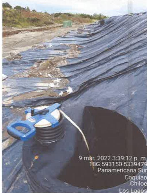
Fotografía N°18: Medición de Niveles de cámaras por Personal Municipal. Tomada: 09 de Marzo del 2022.
